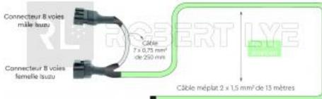
Faisceau principal de 13 mètres pour alimentation des feux latéraux, de gabarit, ou haut de caisse. Se branche en dérivation entre les deux connecteurs 8 voies situés sur les châssis des Isuzu série N.
